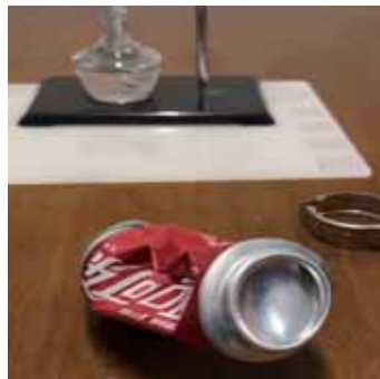
图1 被大气压压瘪的易拉罐
