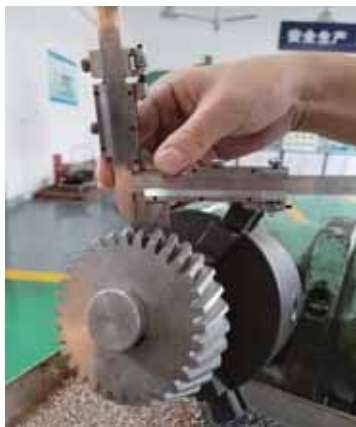
图5 螺旋锥齿轮测量图
