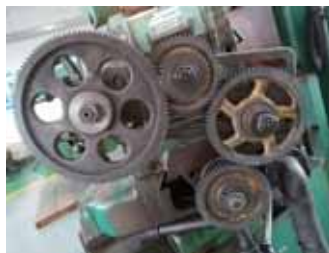
图3 螺旋锥齿轮挂轮图
