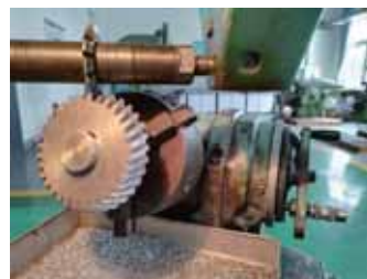
图4 螺旋锥齿轮加工图
